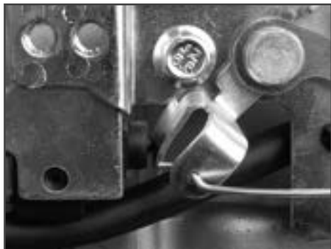
Рис. 6 Рычаг управления и выключатель зажигания
