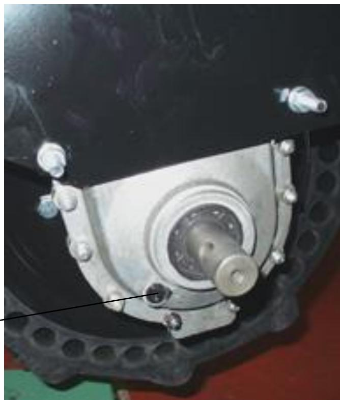
Рисунок 14 – Сливная пробка коробки переключения передач с редуктором
