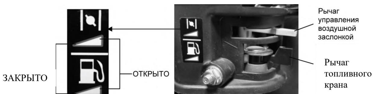
Рисунок 11 – Подготовка запуска двигателя
