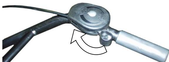
Рисунок 12 – Рычаг управления газом
